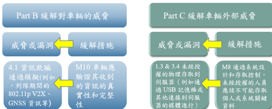
圖 6. B 部分描述適用於車輛型式對威脅的緩解措施及 C 部分描述用於車輛區域外部對威脅的緩解措施範例說明
