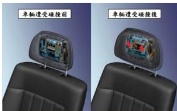
圖五、感應式主動頭枕作動圖
