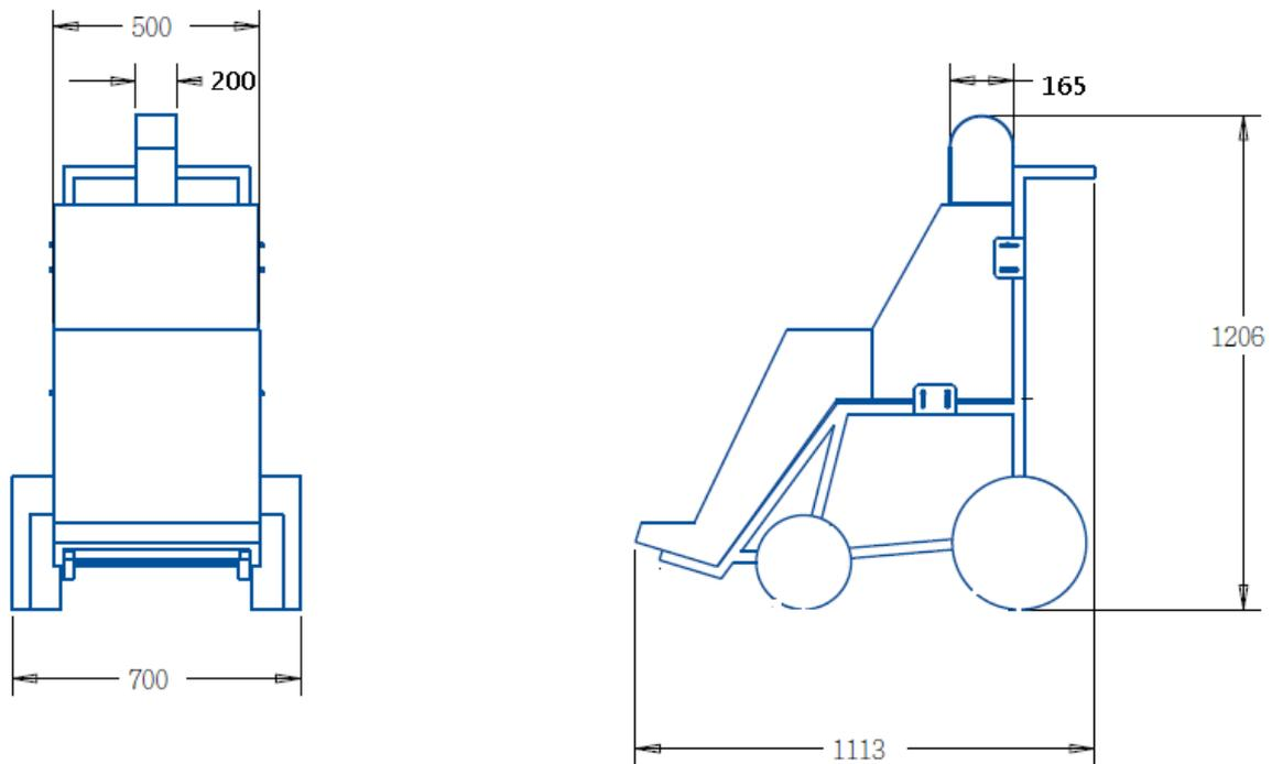
圖二、試驗量具示意圖及尺寸規定
