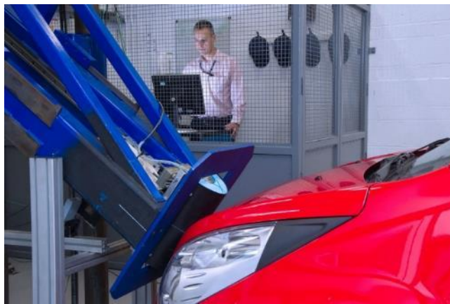
圖六、保險桿之上腿部模型衝擊試驗示意圖
