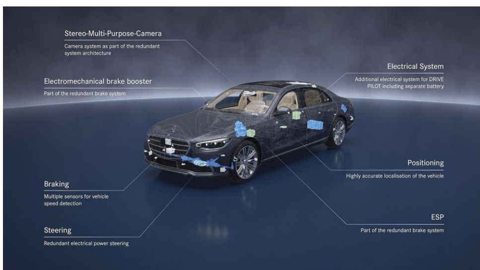
圖13. 確保安全條件式自動駕駛的冗餘系統
