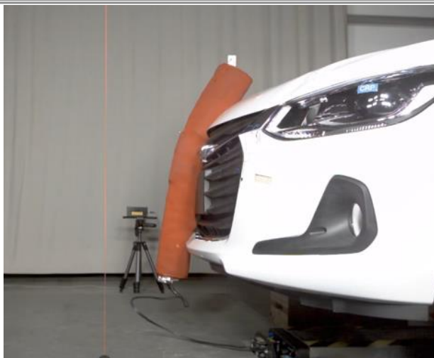
圖四、保險桿之撓性下腿部模型衝擊試驗示意圖
