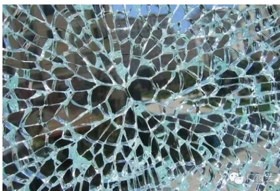
圖二 破碎後的強化玻璃
