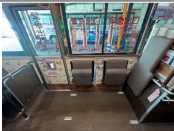
圖 3、輪椅區後方未設置隔板及/或欄杆
