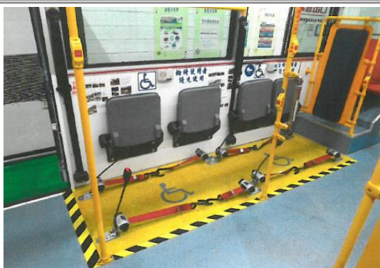
法規修正前之輪椅區靠窗側未設置扶手
