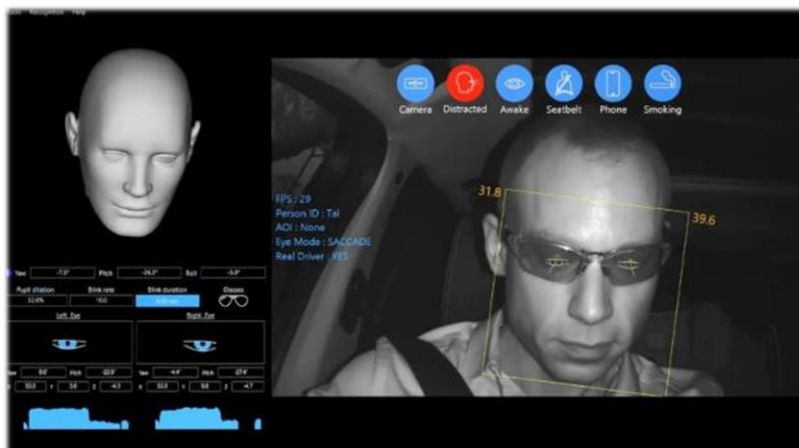
圖八、駕駛者監控系統(DMS)偵測臉部區域關鍵點，並形成相應的臉部模型
